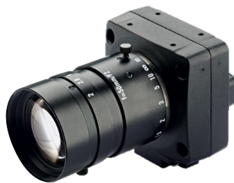
Mystique Cinema 的自动校准图像校正软件和摄像机套件能够在数秒内轻松实现并保持两台放映机的图像校正, 为大银幕提供轻松的维护与卓越的观影体验。
